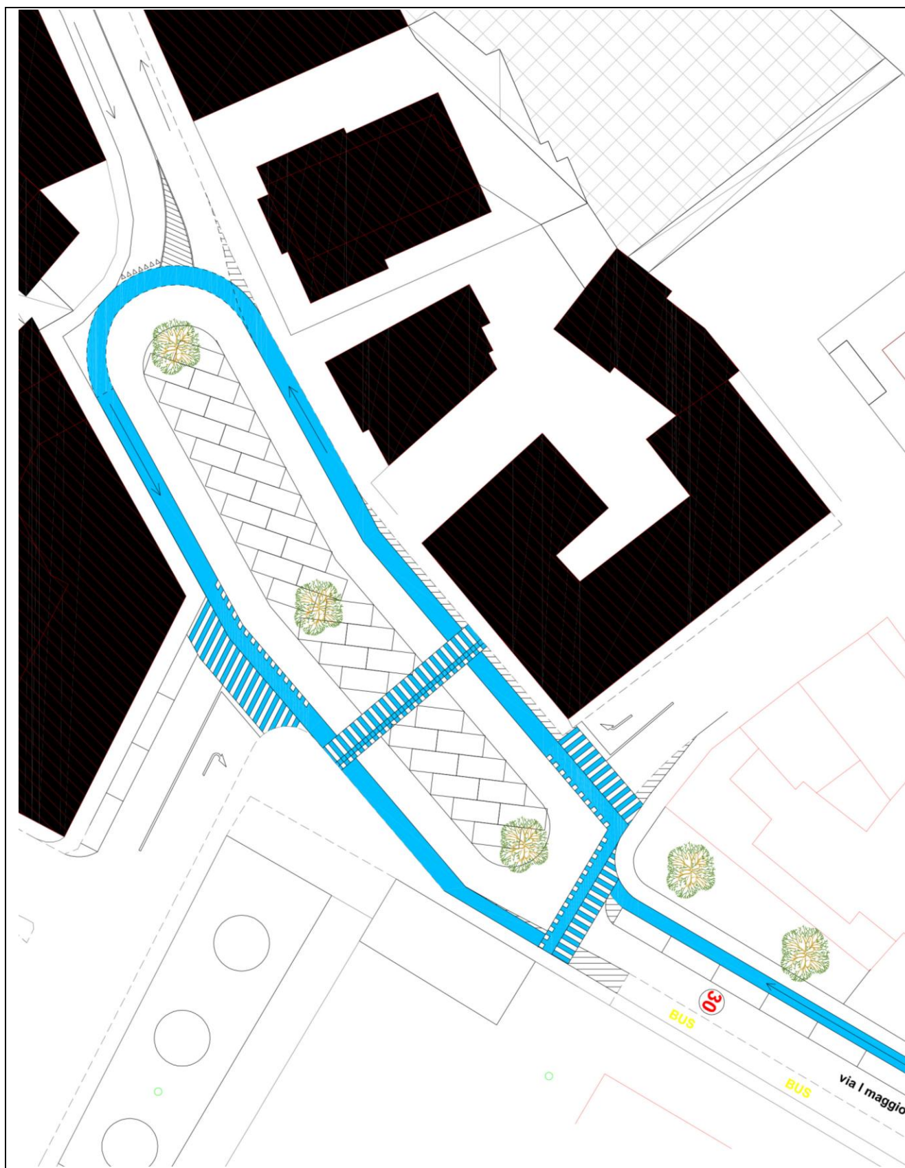
Schema generale del nuovo assetto viario, prevedendo lo spostamento del dehor ubicato all'angolo di Via Pecori Giraldi; gli stalli di sosta complessivamente disponibili sono 34
