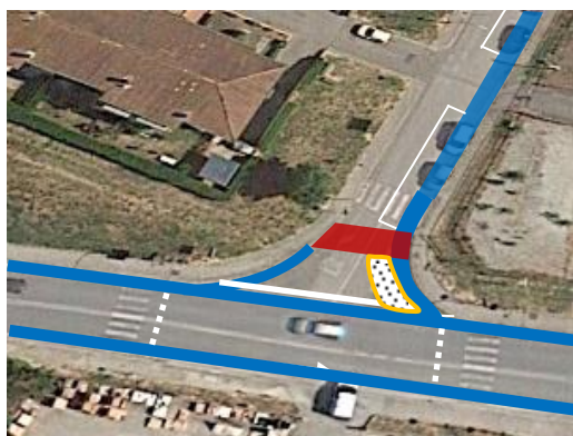
Intersezione tra Via Nenni e Via Caiani; i due attraversamenti ciclabili di Via Caiani vengono modificati in ciclo pedonali, per proteggere la svolta a sinistra dei ciclisti in entrata o uscita da Via Nenni; si noti che l'attraversamento pedonale di Via Nenni è stato spostato più a ridosso dell'intersezione per agevolare i pedoni
