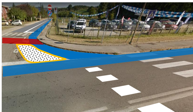
Intersezione tra Via Nenni e Via Caiani; i due attraversamenti ciclabili di Via Caiani vengono modificati in ciclo pedonali, per proteggere la svolta a sinistra dei ciclisti in entrata o uscita da Via Nenni; si noti che l'attraversamento pedonale di Via Nenni è stato spostato più a ridosso dell'intersezione per agevolare i pedoni
