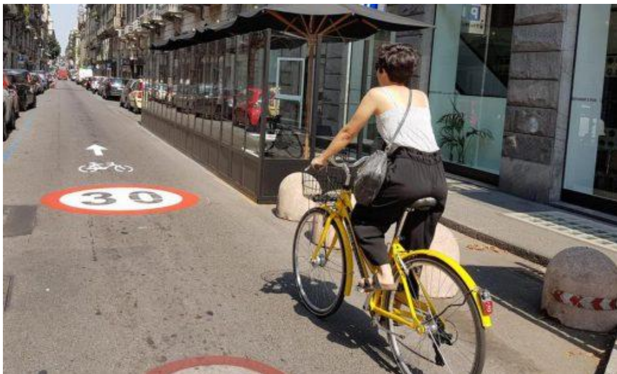
Esempio di segnaletica orizzontale che indica ai ciclisti di utilizzare la corsia veicolare
