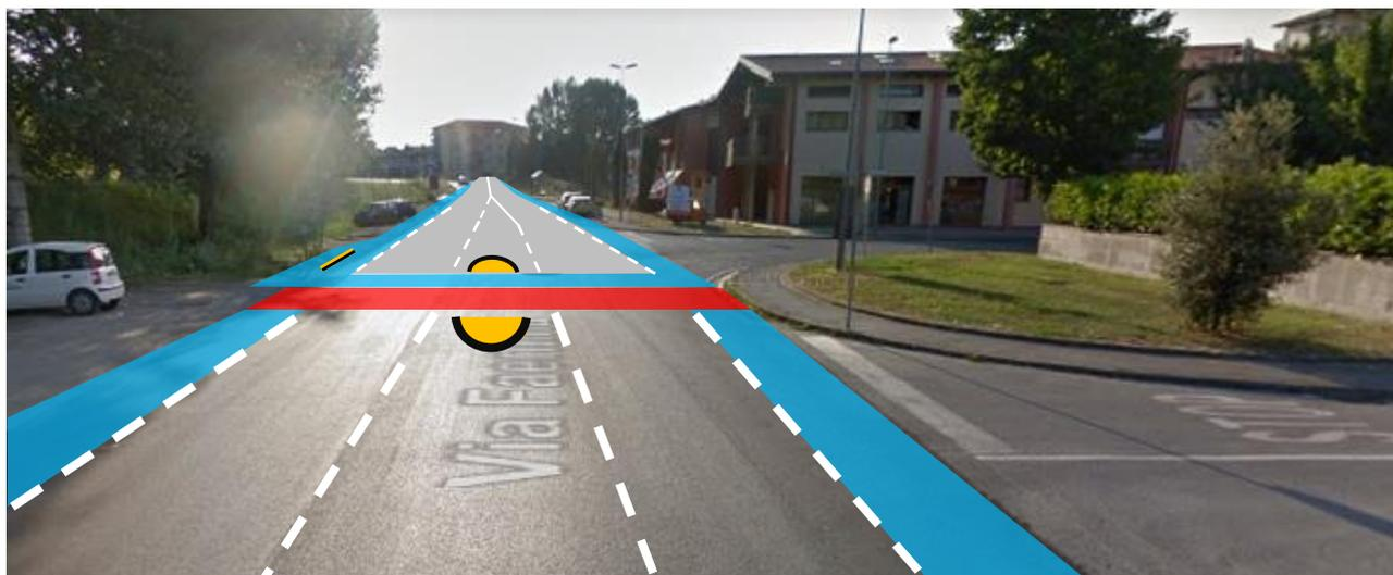
**La presenza di due elementi spartitraffico contribuisce alla moderazione della velocità dei veicoli ed offre protezione all'attraversamento. Si noti che l'inserimento delle corsie ciclabili e del nuovo attraversamento ciclopeditonale non vanno minimamente a modificare lo schema della viabilità.**
