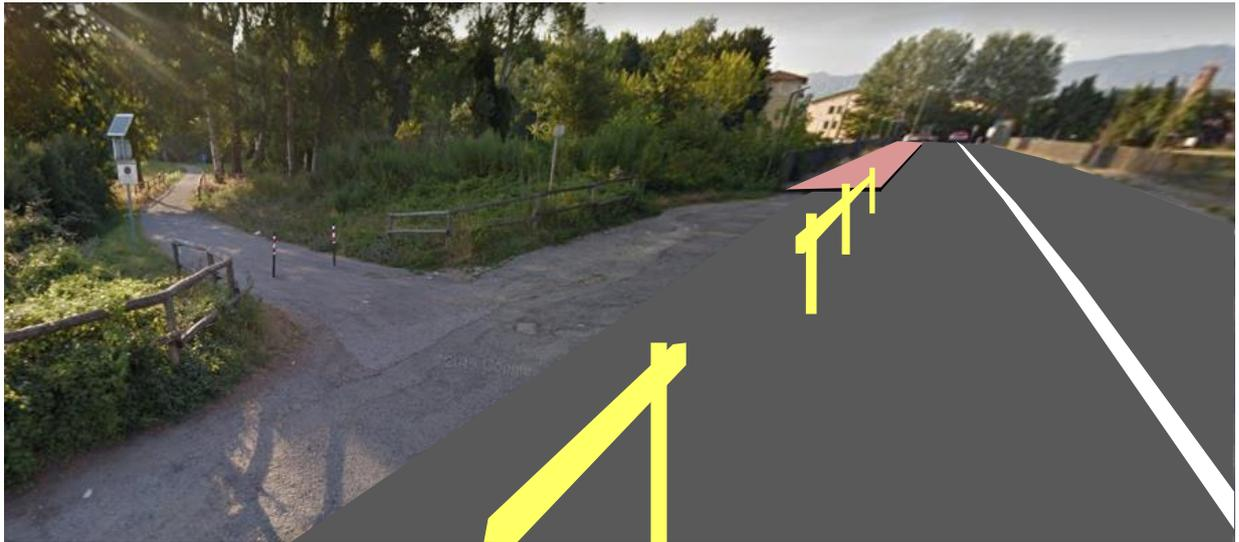
*Per proteggere l'ingresso al percorso ciclopedonale è sufficiente posizionare una balaustra in legno (o una serie di altri dissuasori) in continuità con il profilo del marciapiede Ovest (allargato) del ponte*
